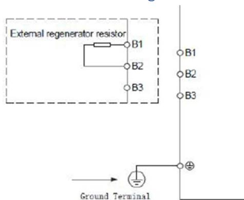
La résistance de freinage permet l'absorption de l'énergie restituée par le moteur durant une décélération.
