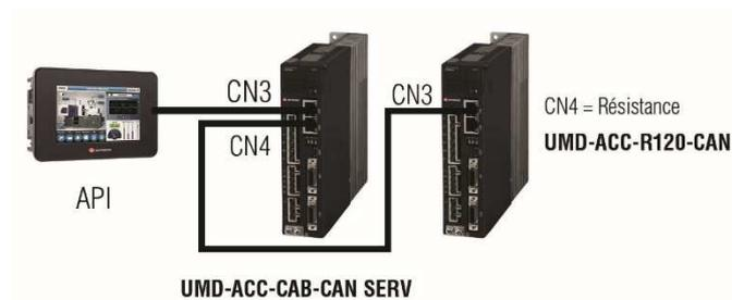
La résistance de terminaison UMD-ACC-R120-CAN est obligatoire dans un réseau CAN
