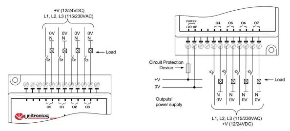
Notes: 1. L'adaptateur et l'alimentation des sorties doivent être connectés au même signal 0V.
