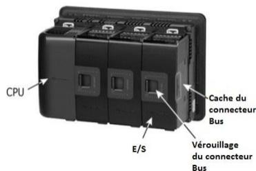
7. Si l'extension est la dernière dans la configuration laissez le connecteur du Bus d'E/S couvert.
