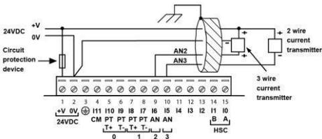
Câblage d'entrée analogique, courant (4-câbles), et tension
