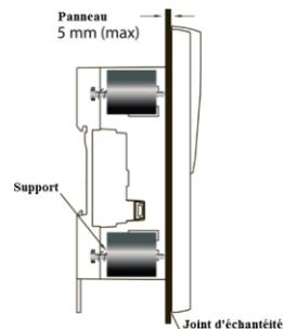
**Note:** La suppression de l'unité nécessite un espace libre. Recommandation: environ 40mm. Pour le module listé UL, afin de répondre à la norme UL508, le montage sur panneau de ce dispositif se fait sur la surface plane d'un boîtier de type 1.
