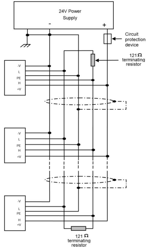
Terminaisons de réseau : Placez les terminaisons à chaque extrémité du réseau CANbus. La résistance doit être configurée sur 1%, 121Ω et 1/4W.
