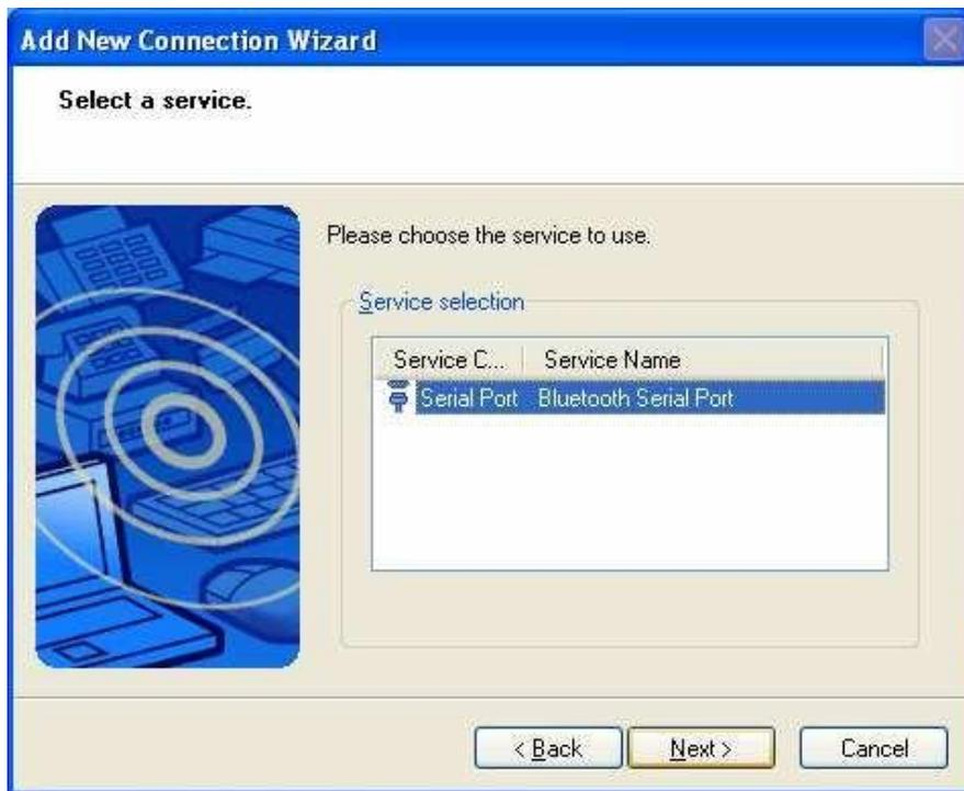
9. Ne pas sélectionner « port COM par défaut », choisir le port de communication virtuel entre 1-15 (suivant VisiLogic)
